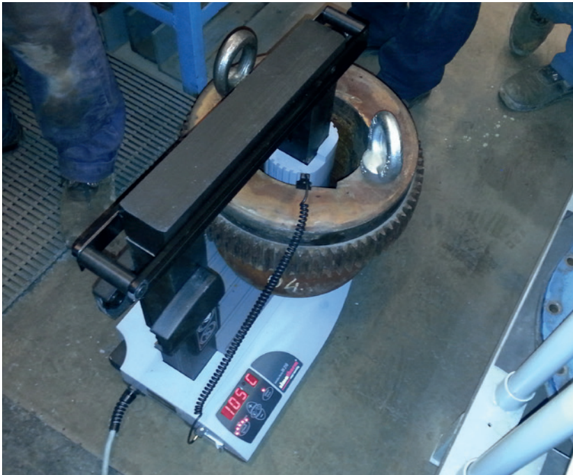
O simatherm IH 210F aquece o cubo de acoplamento.
