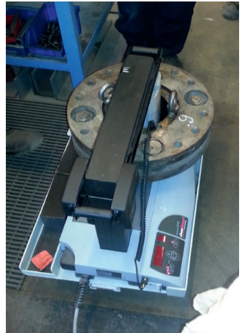
O cubo de acoplamento é aquecido a 110°C em menos de 10 minutos.
