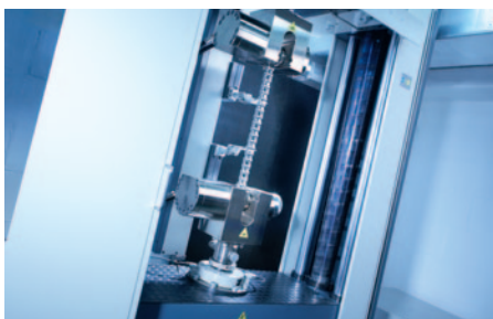
Bruchkraftermittlung und Dehnungsaufnahmen bis 1000kN Evaluation of chain breaking strength and elongation up to 1000kN
