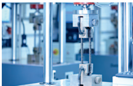
Dauerfestigkeits- und Zeitfestigkeitsüberprüfungen durch mehr als 15 Pulsatoren nach unterschiedlichen Prüfungsverfahren More than 15 pulser are available for testing dynamic fatigue strength according to different testing methods
