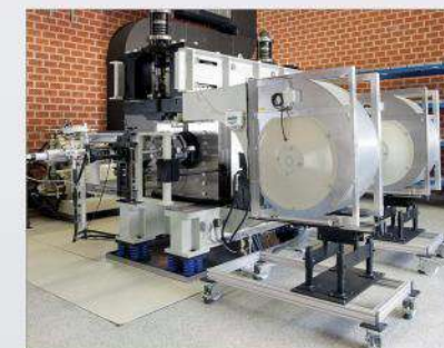
Aplicações ferroviárias – Rolamentos para caixas de eixo. Ensaio de verificação do desempenho EN 12082
