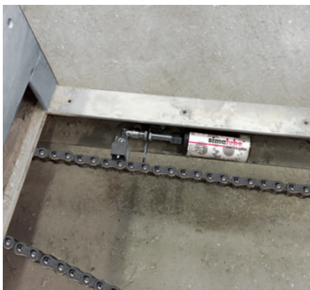
Se não há restrições de espaço, o simalube pode ser instalado em ângulo.
