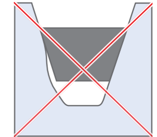
Polia de correia em v desgastada
