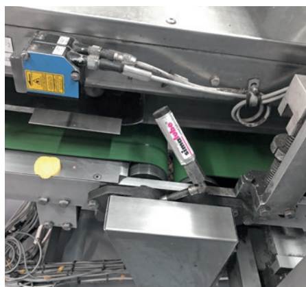
Lubrificação de rolamento no rolo de transmissão de um tapete transportador na produção de batatas fritas.
