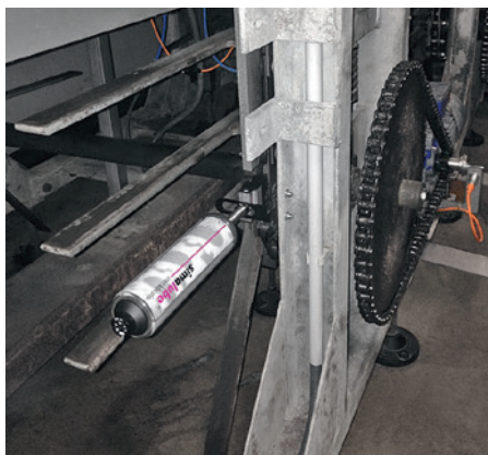
Lubrificação de corrente com simalube 250 ml e escova plana.
