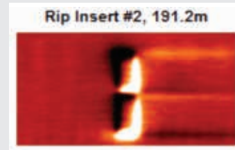
Longitudinal Rip Detection
