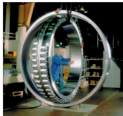
Montagem de um rolamento grande
