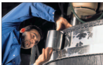
Inspeção do assento dos rolos
