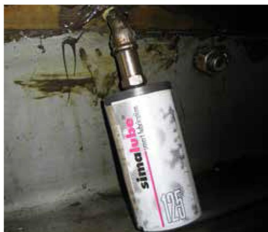
Foto detalhada da lubrificação de um cabo de tracção.
