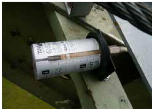
simalube ® lubrifica o cabo de tracção do teleférico Gemmi em cada pilar.
