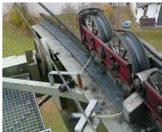
simalube ® com capa protectora lubrifica as polias.
