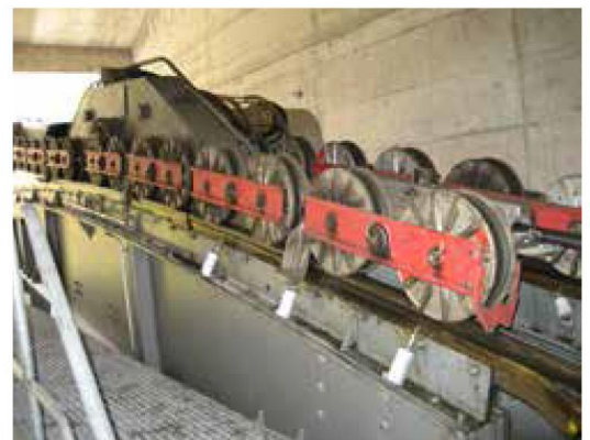
simalube ® é usado para lubrificar o cabo de tracção do teleférico Matterhorn Glacier Paradise.
