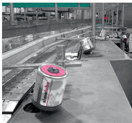
Linha de enchimento equipada com vários lubrificadores simalube.
