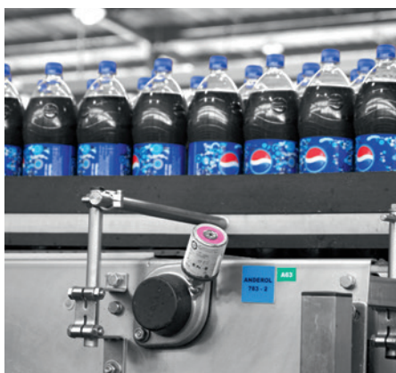
Lubrificação de um rolamento com flange numa máquina de enchimento de refrigerantes.
