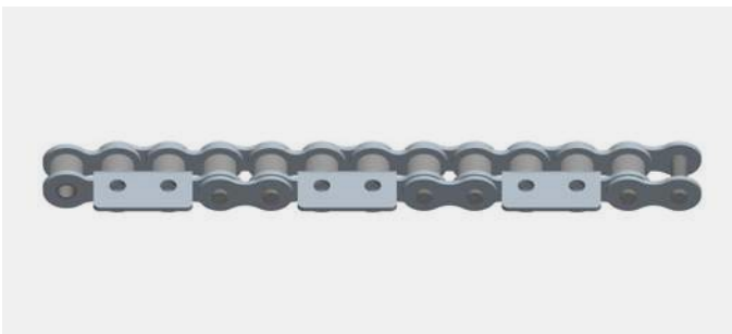
Kette mit K2 Winkel beidseitig an jedem 2. Außenglied Roller chain with attachment K2 every other outer link on both sides
