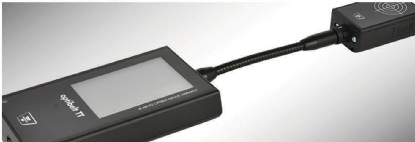
O medidor de frequência optibelt TT destina-se a **testar a pré-tensão de correias de transmissão** através da medição da frequências.
