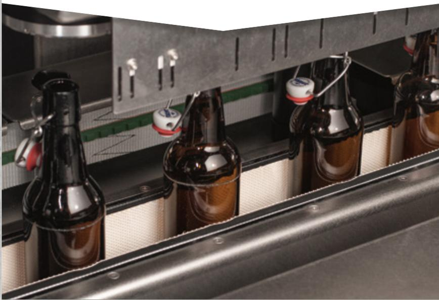
A empresa alemã Hesse MIHO é um dos principais fabricantes de sistemas de inspeção de garrafas vazias. Nos sistemas de inspeção controlados por câmara, as correias de transporte absorviam demasiada humidade, levando a rejeições indesejadas e contaminação biológica.
