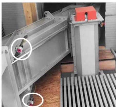
Numa serração, os rolamentos de um transportador de corrente estão a uma altura inacessível. Estes podem ser monitorizados convenientemente graças à conexão Bluetooth® do simalube IMPULSE connect.
