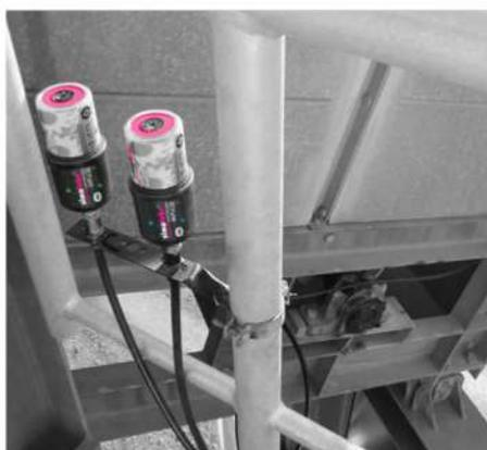
Os pontos de lubrificação estão a uma altura perigosa. Podem ser controlados convenientemente a partir do solo com a app simatec.
