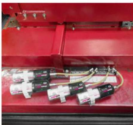
Quatro impulsionadores de pressão de simalube IMPULSE connect lubrificam as guias lineares de uma máquina CNC por meio de conexões de mangueira. Cada IMPULSE pode ser controlado e configurado individualmente com a app simatec.
