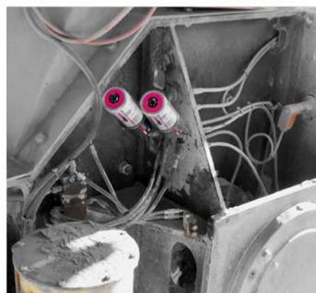
Numa pedreira, dois impulsadores de pressão simalube IMPULSE connect superam sem esforço a contrapressão de dois rolamentos. Estes também foram incluídos no plano de lubrificação simalube «Lubechart» através da app simatec.
