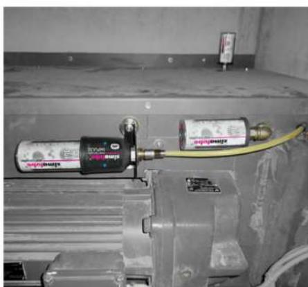
O lubrificante é fornecido através de uma linha longa. Um suporte de montagem com dois ímãs fixa o simalube IMPULSE connect à máquina.
