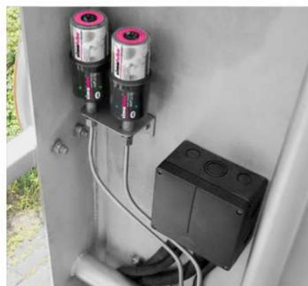
Devido às linhas de lubrificação permanentemente instaladas na limpeza de uma piscina, são usados dois simalube IMPULSE connect. Eles superam a contrapressão e garantem lubrificação contínua.
