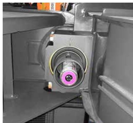
O acoplamento de duas carruagens é lubrificado com simalube 125 ml.
