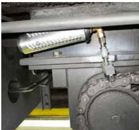
O lubrificador simalube 250ml lubrifica continuamente a corrente de uma grua.
