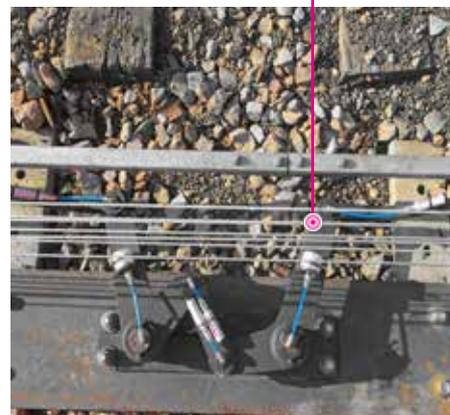
Dois lubrificadores simalube 30 ml e quatro de 15ml lubrificam continuamente o compensador de um Sistema de sinalização.
