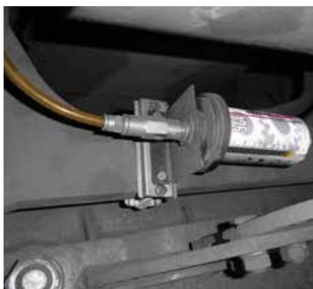
O lubrificador de 125 ml está instalado no chassi de um veículo de piso baixo. O lubrificante é direcionado através de uma mangueira ao ponto de lubrificação.
