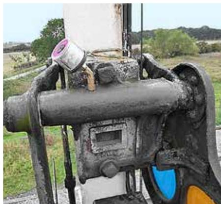
O rolamento de um sinal ferroviário é automaticamente e continuamente lubrificado por um copo simalube de 30 ml.
