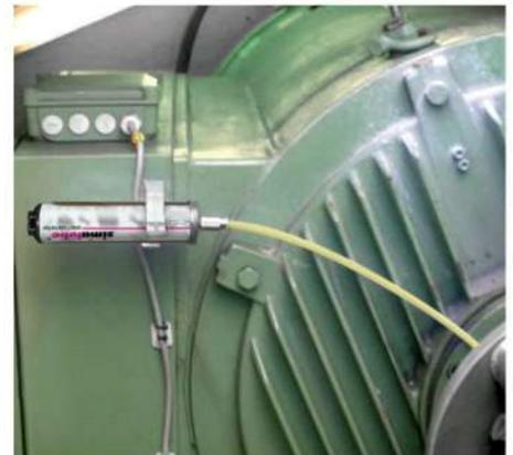
Com o lubrificador simalube 250 ml, o gerador é constantemente abastecido com lubrificante até 12 meses.
