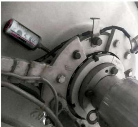
Com os práticos acessórios simalube, é possível equipar facilmente cada ponto de lubrificação com um copo simalube.
