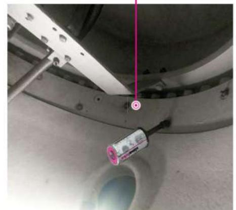
Lubrificação automática com o simalube de 125ml num rolamento das pás.
