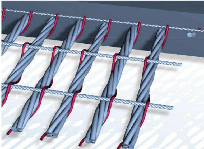
O resultado é uma camada consistente, dificilmente penetrável, resistente a cortes, com um alongamento de trabalho até a um máximo de 0.5%
