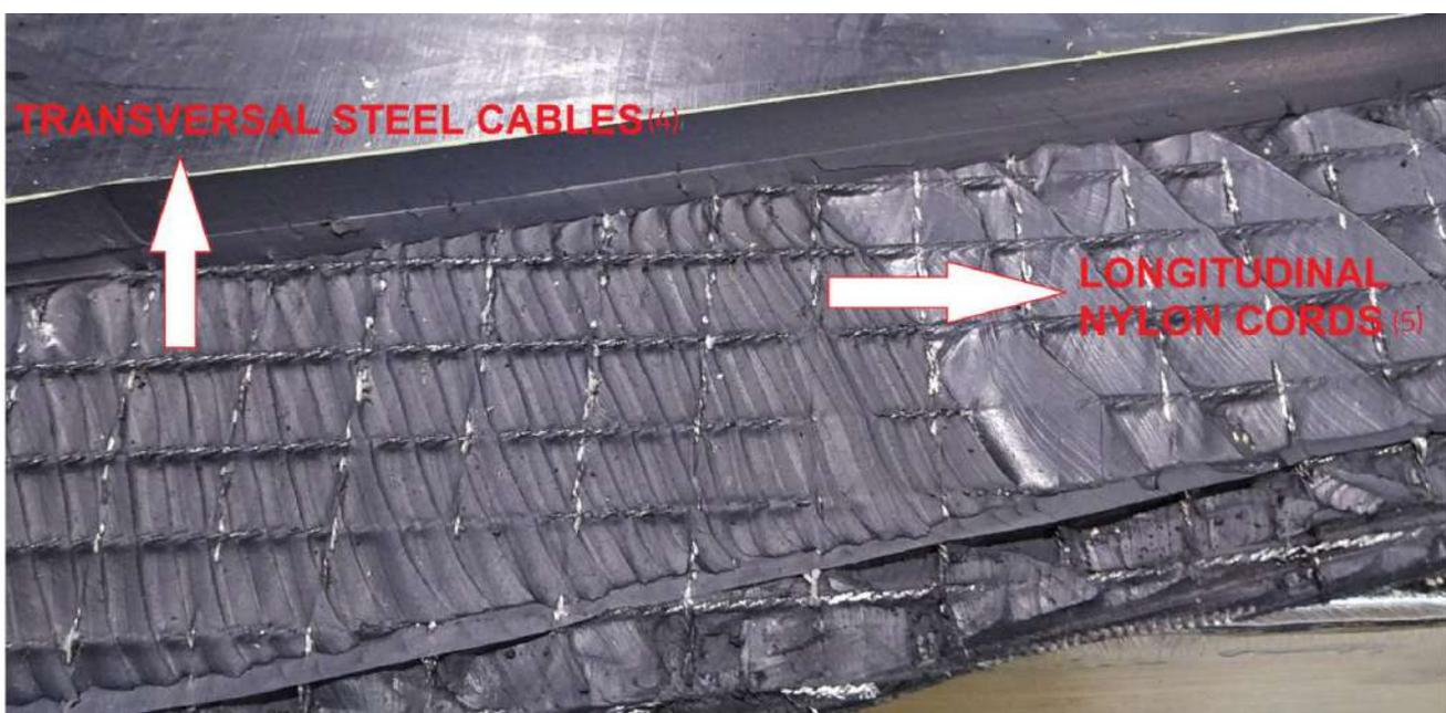
4- Cabos de aço transversais 5 - Cabos de nylon longitudinais
