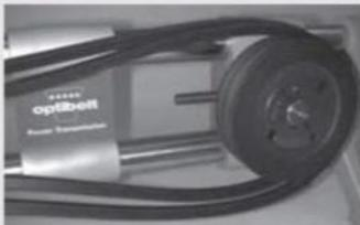
a) Possibilidade de ajuste da distância entre eixos insuficiente
