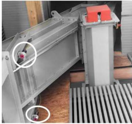
Numa serração, os rolamentos de um transportador de corrente estão a uma altura inacessível. Estes podem ser monitorizados convenientemente graças à conexão Bluetooth® do simalube IMPULSE connect.
