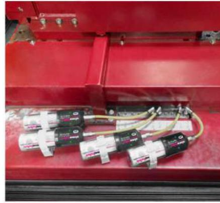
Quatro impulsionadores de pressão de simalube IMPULSE connect lubrificam as guias lineares de uma máquina CNC por meio de conexões de mangueira. Cada IMPULSE pode ser controlado e configurado individualmente com a app simatec.
