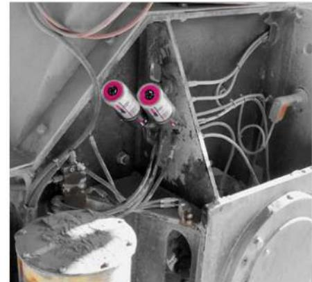
Numa pedreira, dois impulsionadores de pressão simalube IMPULSE connect superam sem esforço a contrapressão de dois rolamentos. Estes também foram incluídos no plano de lubrificação simalube «Lubechart» através da app simatec.
