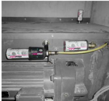
O lubrificante é fornecido através de uma linha longa. Um suporte de montagem com dois ímans fixa o simalube IMPULSE connect à máquina.
